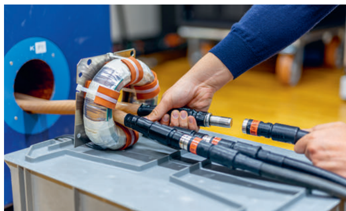
Taratura di strumenti di misurazione per la determinazione dei parametri di rete.
